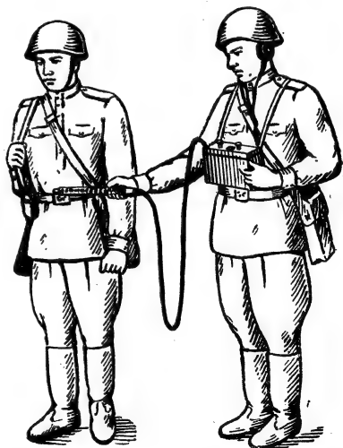
Рис. 141. Положение радиометра ДП-12 при измерении
